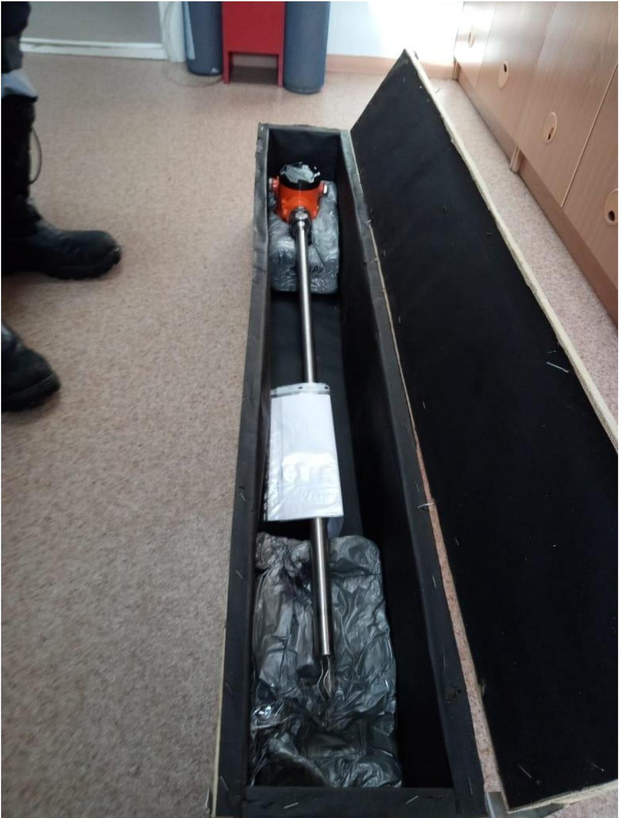
Рисунок 1: Сигнализатор уровня Вибротач Комплектация
