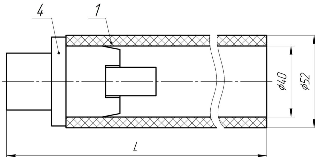
Рисунок 2 – Пробоотборник типа ПМ-А
