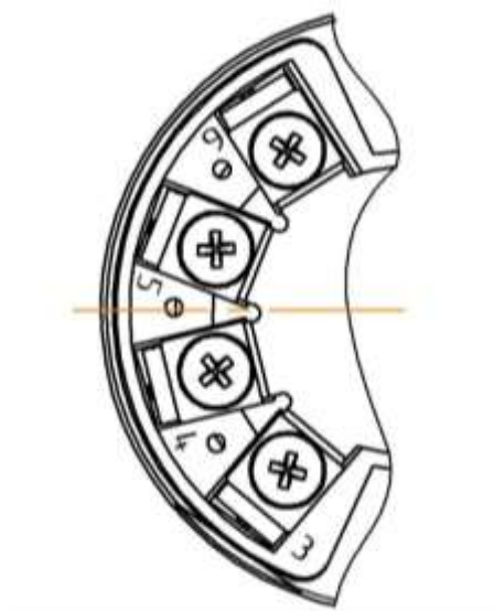
Рисунок 3 – Клеммы для подключения входного сигнала
